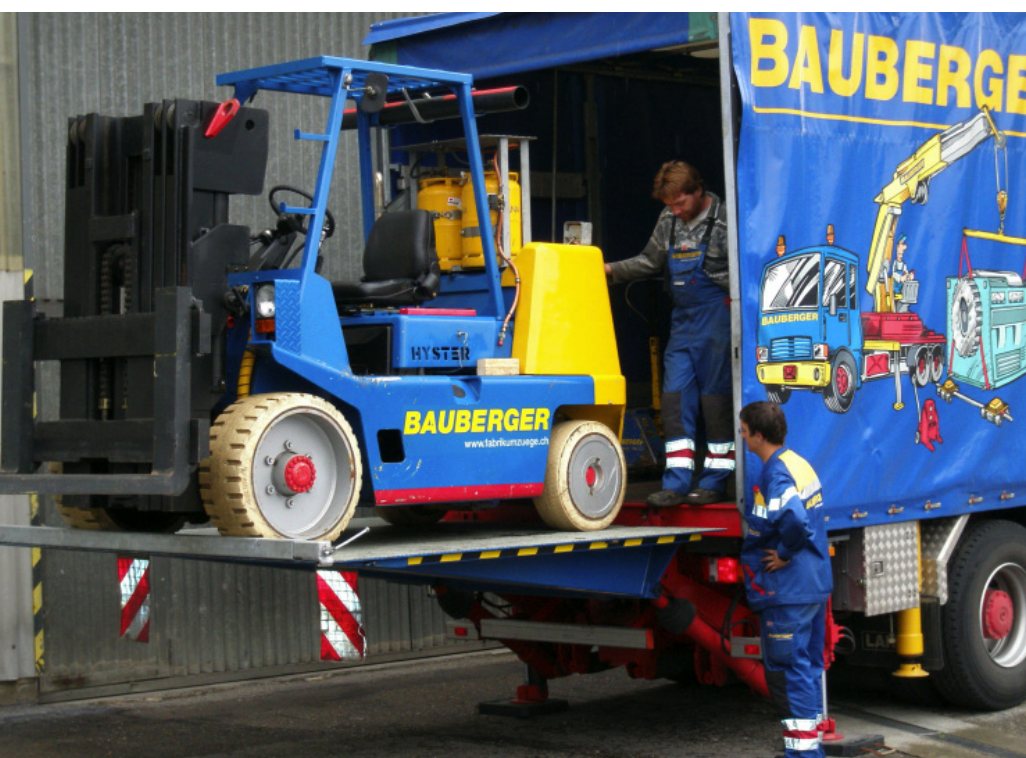
Da staunt der Laie: Ein 10 Tonnen schwerer Hyster-Stapler wird per Hebebühne auf den LKW verladen und an den Einsatzort transportiert. (Bilder: Feurstein / BAUBERGER AG)
